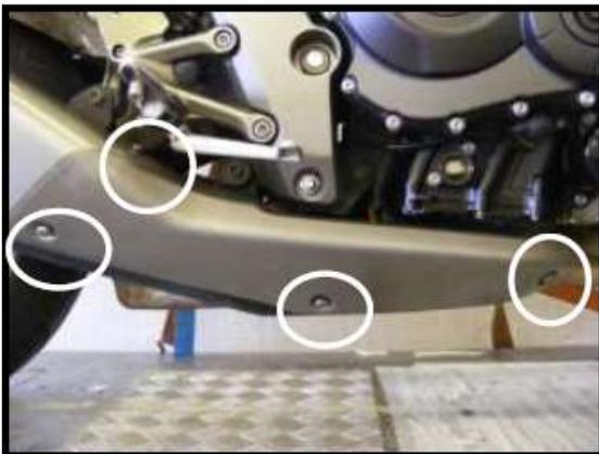
Installare le staffe utilizzando i punti di fissaggio esistenti e lasciarle lente
